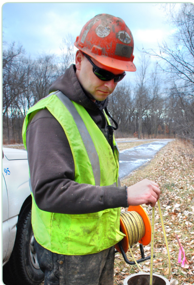
Farsanayaqaan ayaa ku rakibaya qalab lagu qiyaaso biyaha dhulka ku jira mid ka mid ah xarumaha lagala socdo ee Kenilworth.
