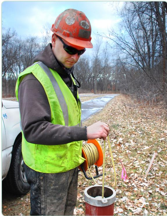
*Un técnico coloca un indicador del nivel de aguas subterráneas en una de las diferentes estaciones de monitoreo en la zona de Kenilworth.*
