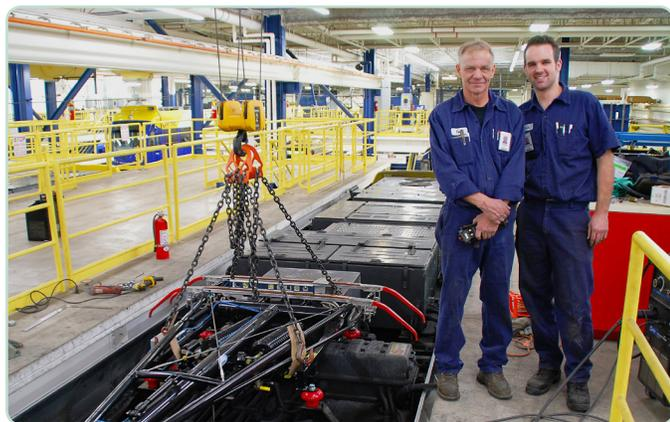
*Técnicos de mantenimiento de los componentes eléctricos en el techo de un vehículo de tren ligero en el complejo de mantenimiento y operaciones METRO Línea Azul.*
