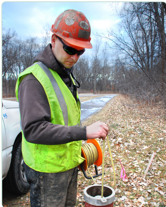
Ib tus kws ua hauj lwm yuav ntxig tus pas ntsuas dej hauv qab av rau ntawm ib thaj ntawm ntau thaj chaw los mus soj ntsuam cov tsev tos tsheb hauv thaj tsam Kenilworth.
